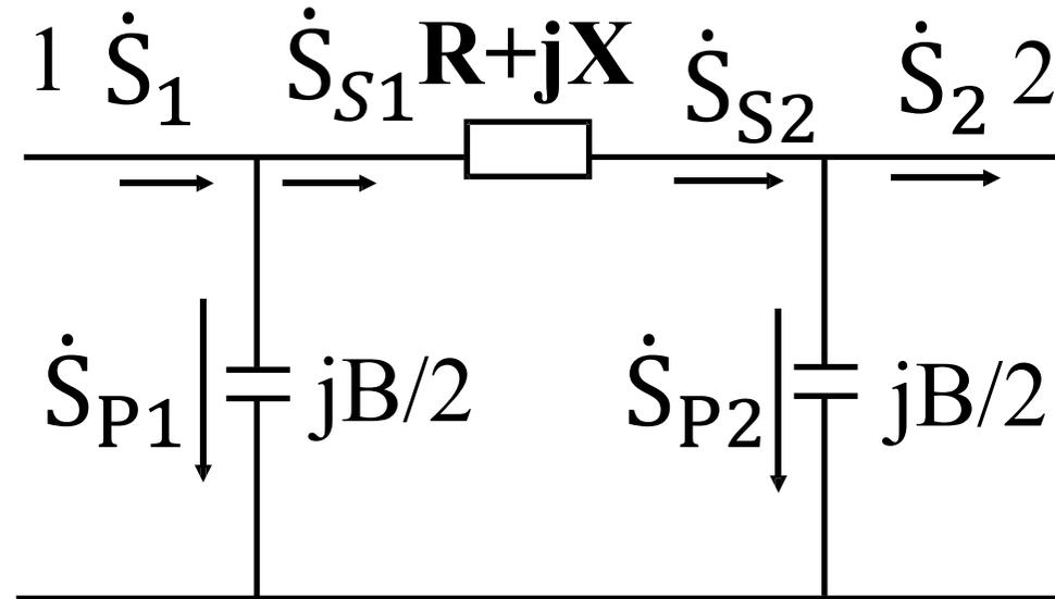
线路总损耗:  $\Delta \dot{S}_L = \Delta \dot{S}_S + \Delta \dot{S}_{P1} + \Delta \dot{S}_{P2}$
