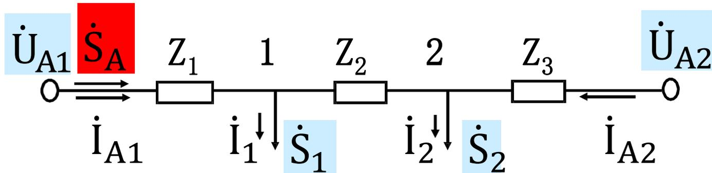
$$\dot{U}_{A1} - \dot{U}_{A2} = \dot{I}_{A1}Z_1 + (\dot{I}_{A1} - \dot{I}_1)Z_2 + (\dot{I}_{A1} - \dot{I}_1 - \dot{I}_2)Z_3$$
