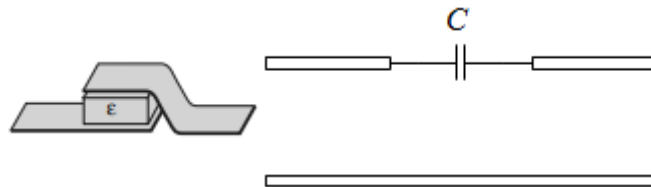
(a) 中心导体上的迭层电容结构图 (b) 对应等效电路
