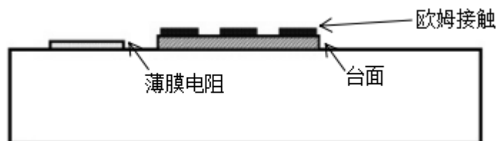
图 6.3-11 溅射薄膜，形成薄膜电阻（TFR）
