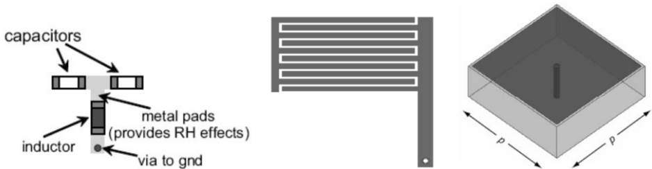
（a）集总元件法（b）交指电容法（c）蘑菇云结构法
