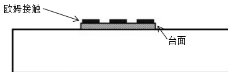
图 6.3-10 蒸发金属层，形成欧姆接触
