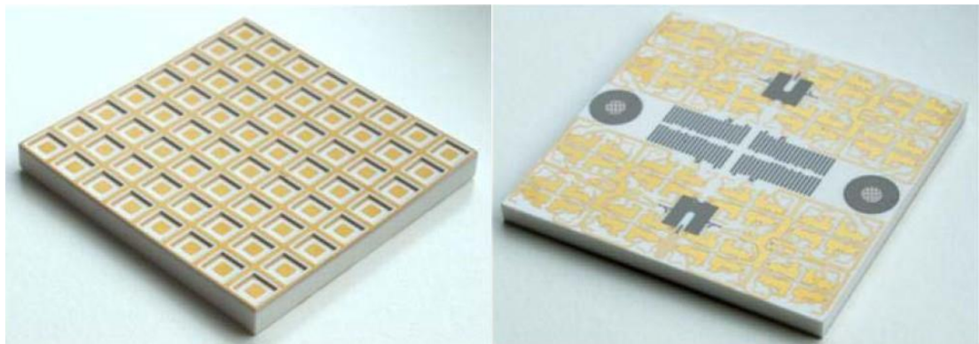
图 5.7-31 高集成度 Ka 频段 LTCC 收发模块
