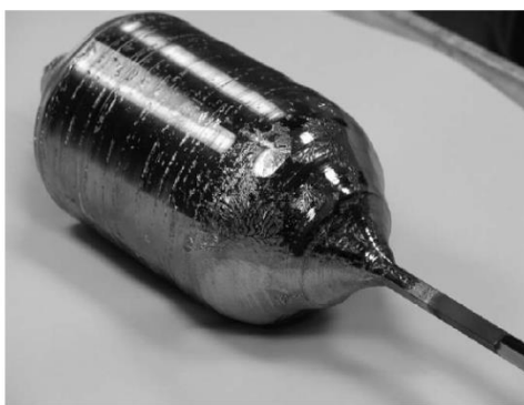
图 6.3-3 一个利用液封提拉法生长的三英寸磷化铟晶锭
