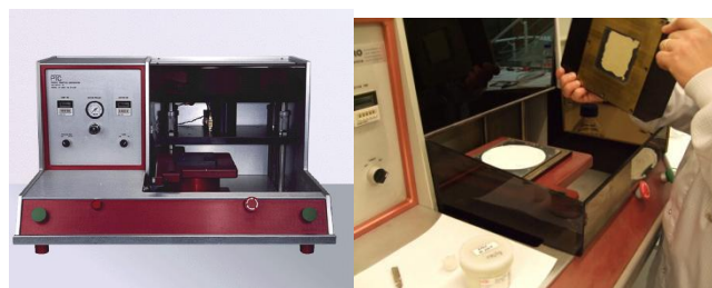
图 5.7-10 模板挤压法进行通孔填充
